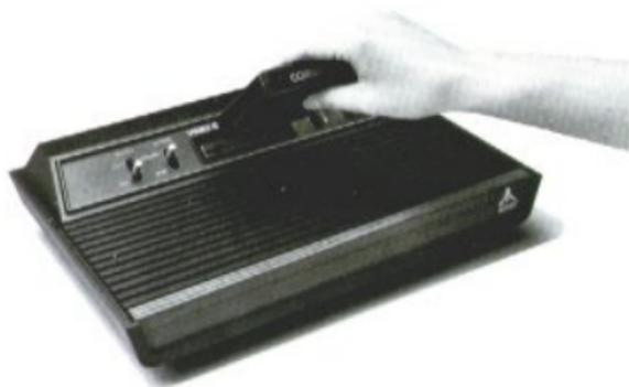
■ Vor dem Einstecken oder Herausziehen einer ProgrammCassette den Schalter "POWER" immer auf "OFF" stellen. Dadurch wird die Lebensdauer Ihres ATARI Video Computer Systems und seiner elektronischen Bestandteile verlängert.
