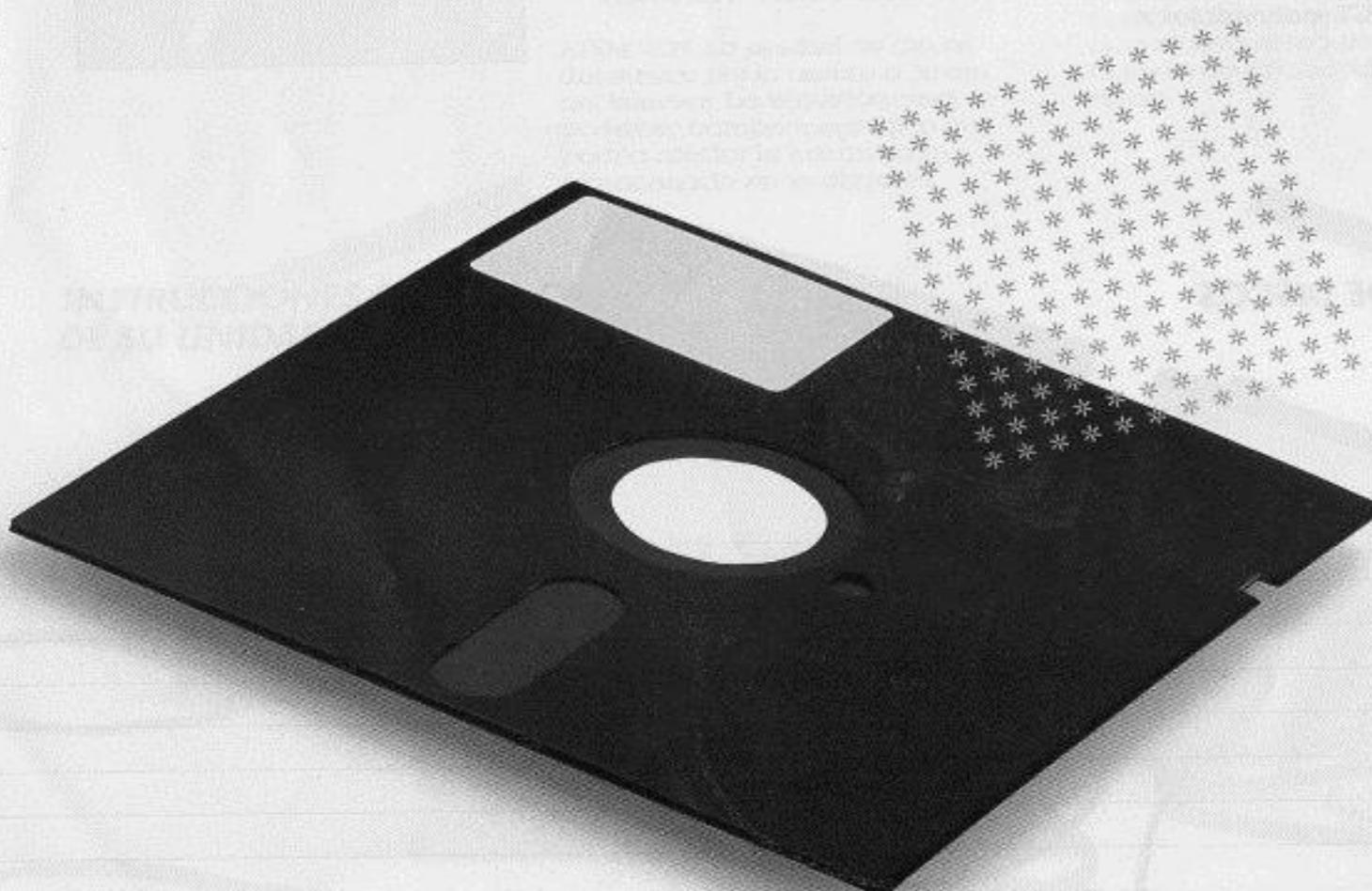
El disco ATARI Master, que es suministrada con la unidad de discos, contiene el sistema operativo de discos (en inglés, DOS = Disk Operating System), que permite a la unidad y al computador almacenar programas y archivos de datos, cargar los archivos en el computador, hacer duplicados de las discetas, etc.
