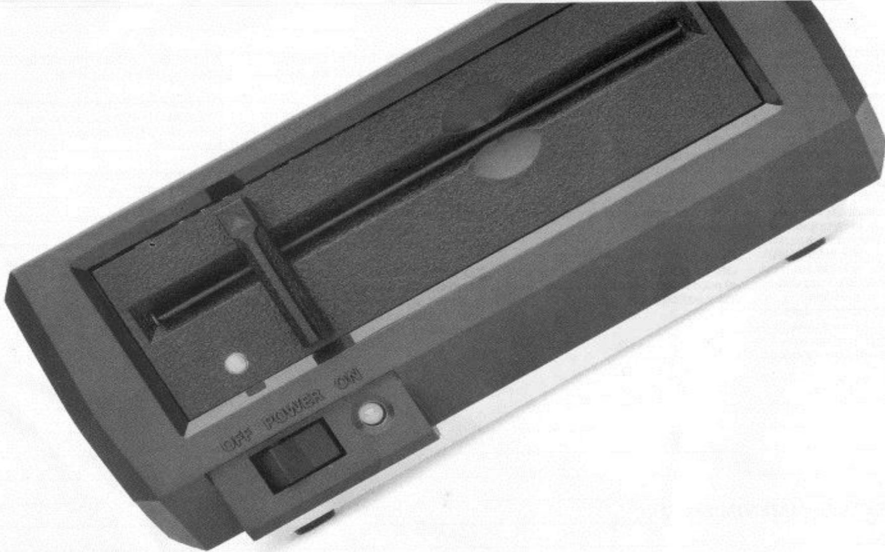
L'unità a disco ATARI 1050 è un dispositivo di memoria estremamente rapido ed efficiente che estende sostanzialmente le possibilità dell'ATARI Home Computer. Vi permette di conservare e gestire importanti quantità di informazioni in archivi separati su floppy disk. Inoltre, vi permette di reperire facilmente i dati catalogati per nome negli archivi, di copiarli o cancellarli e di gestirli in altri modi ancora.
