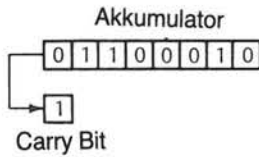
Abb. 10-2 (c) Nach Ausführung der ASL-Anweisung
