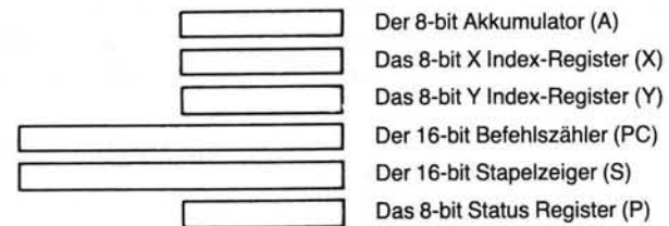
Abb. 1-5 Funktionselemente des Mikroprozessors 6502
