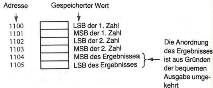
Abb. 9-2 Speicheranordnung für die Zwei-Byte Addition
