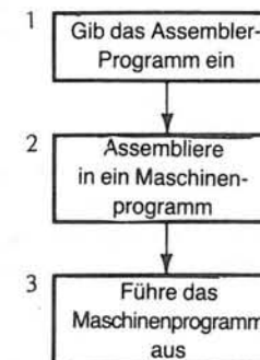
Abb. 1-2 Programmschritte beim Assembler
