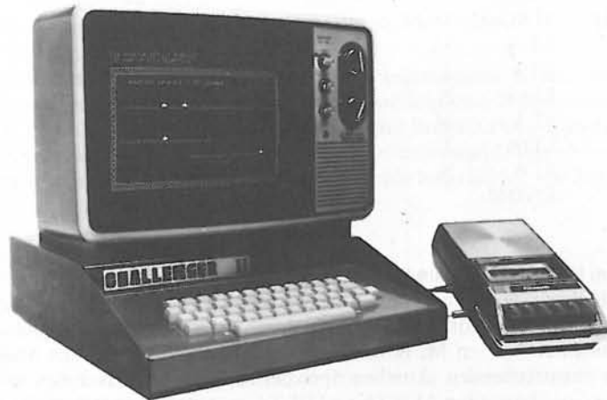
Bild 10-8: Ein Hobbycomputer auf 6502-Basis von Ohio Scientific (OSI)
