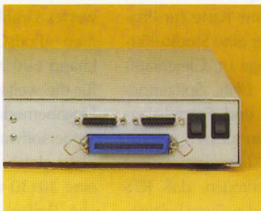
SCSI Schnittstelle an Geräterückseite herausgeführt
