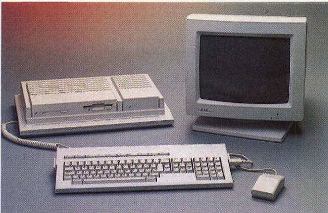
Das TT-Komplettsystem: Zentraleinheit (mit Diskettenlaufwerk und Festplatte), abgesetzte Tastatur, Maus sowie 14-Zoll-Farbmonitor.
