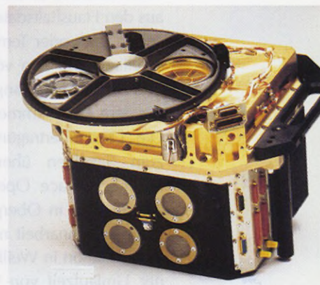
Bild 3. Der positionsempfindliche Proportionalzähler. Bild: MPE
