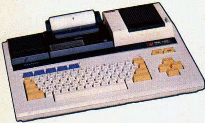
Das aufgerüstete System: Der Sharp MZ-731 mit der Quick-Disk MZ-1F11
