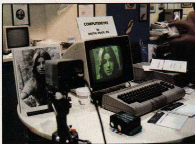
Digitalisierzusatz für den C 64: »Computereyes« von Digital Vision
